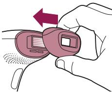
Чтобы снять насадку, потяните за нее и снимите со стеклянного фильтра.
